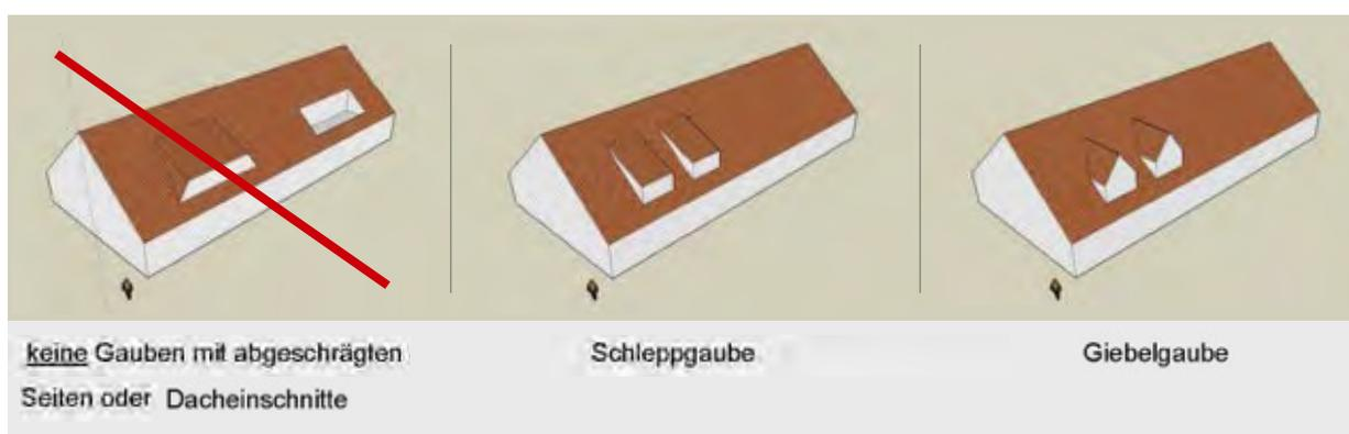
Abb. 92: Beispiele für unzulässige (links) und zulässige (rechts) Dachausbauten
